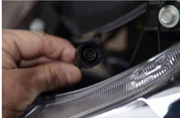
Hier moet dus de o-ring in, niet vergeten!
